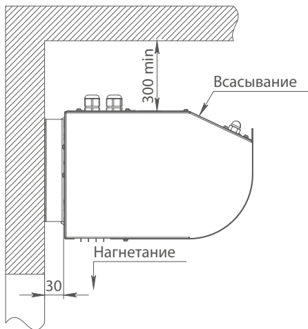
ГОРИЗОНТАЛЬНАЯ УСТАНОВКА к стене с помощью кронштейнов
