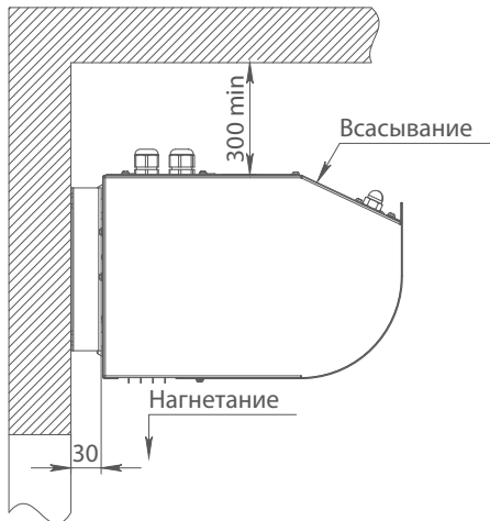
ГОРИЗОНТАЛЬНАЯ УСТАНОВКА к стене с помощью кронштейнов
