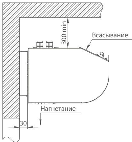
ГОРИЗОНТАЛЬНАЯ УСТАНОВКА к стене с помощью кронштейнов
