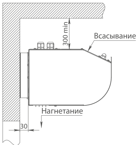
ВЕРТИКАЛЬНАЯ УСТАНОВКА к стене с помощью кронштейнов
