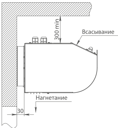
ГОРИЗОНТАЛЬНАЯ УСТАНОВКА к стене с помощью кронштейнов
