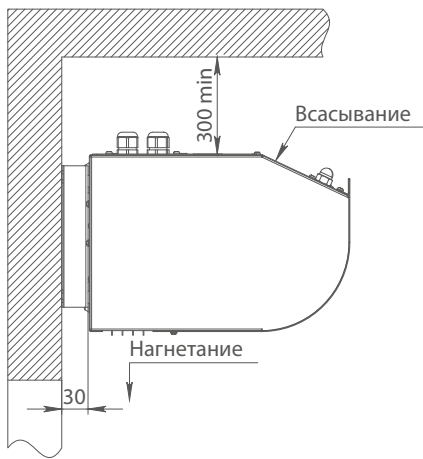
ГОРИЗОНТАЛЬНАЯ УСТАНОВКА к стене с помощью кронштейнов
