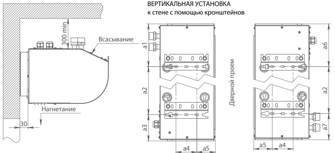
ГОРИЗОНТАЛЬНАЯ УСТАНОВКА к стене с помощью кронштейнов
